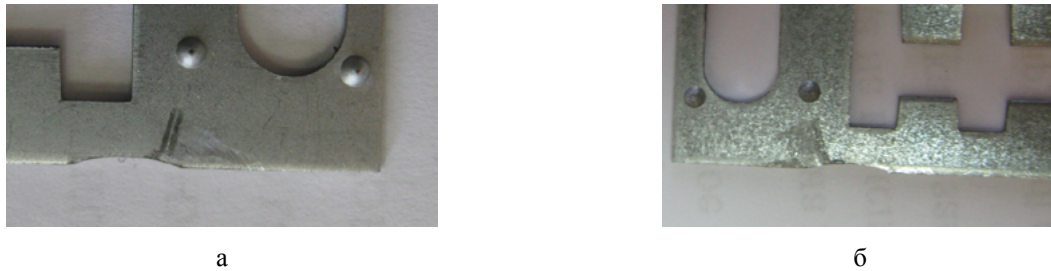
Рис. 3. Следы торцов подвижных частей приспособления на сувальдах, расположенных: а – ближе к крышке, б – ближе к основанию корпуса
