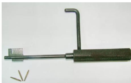
Рис. 1. Устройство, используемое для отмыкания замка с сувальдным механизмом секрета манипуляционным способом
