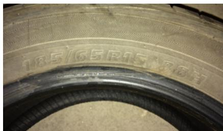
*Иллюстрация 2. Характеристики, расположенные на боковой поверхности шины*
